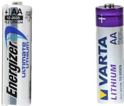
Durch Einsatz dieser beiden Batterie Typen sind Laufzeiten von 1 bis 2 Jahren zu erwarten. Alternativ können wiederaufladbare NiMH Akkus verwendet werden. Diese haben jedoch eine hohe Selbstentladung (bis zu 50% in 6 Monaten) und speichern wesentlich weniger Energie als die Lithium-Eisen Batterien, so dass eine Laufzeit von lediglich 4 bis 6 Monaten zu erwarten ist.
