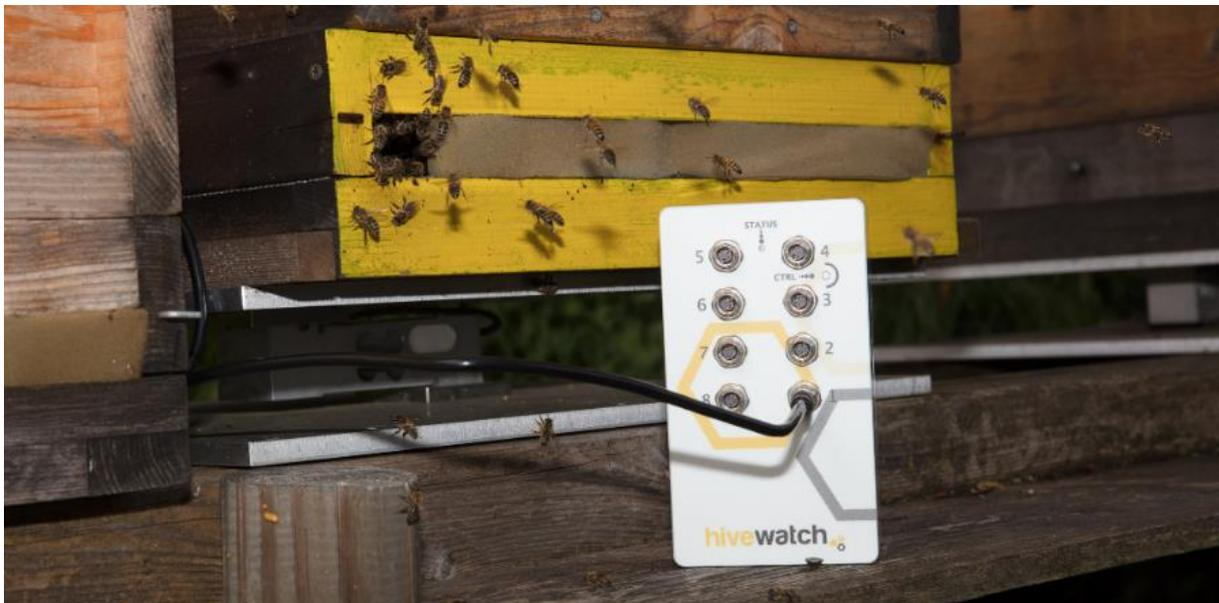
Sofern die Stecker richtig ausgerichtet sind, lassen sich die Stecker gut und ohne hohen Widerstand verschrauben. **Da es sich um ein extrem präzises Messsystem handelt, muss unbedingt darauf geachtet werden, dass die Steckerkontakte auf keinen Fall verschmutzt sind oder mit Wasser in Kontakt kommen.** Aus diesem Grund die Installation bei gutem Wetter durchführen, damit keine Feuchtigkeit und Schmutz in die Stecker gelangen kann.
